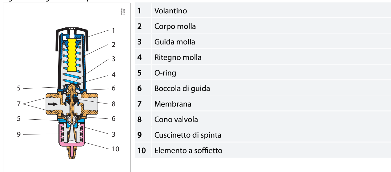
Figura 1: Design/Funzione per WVFX 10 – 25
